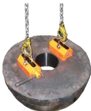
Грузы удерживаются на подошве захвата благодаря генерации магнитного поля постоянными магнитами.
